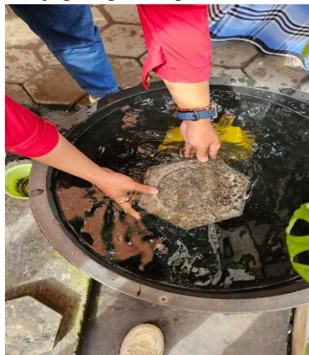
Gambar 5. Proses Pendinginan Pada Pembuatan Paving Block
