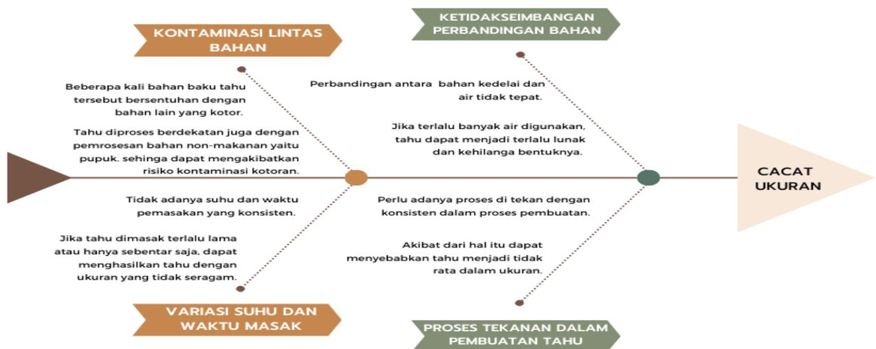
**Gambar 9** Fishbone Tahu Cacat Ukuran
