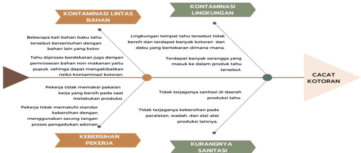
Gambar 7 Fishbone Tahu Cacat Kotoran
