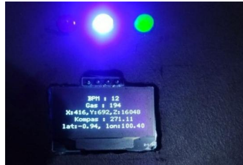
Gambar 13. LCD pada perangkat receiver menampilkan data
