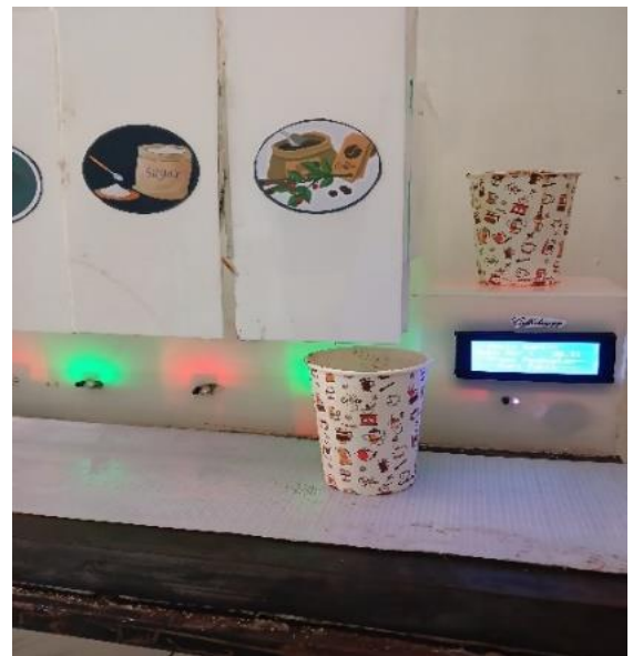
Gambar 10. Proses pengisian kopi, susu dan gula ke dalam gelas secara otomatis
