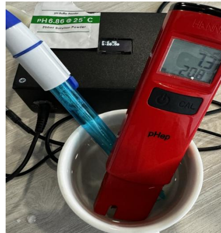
Gambar 9. Tampilan pengujian sensor ph
