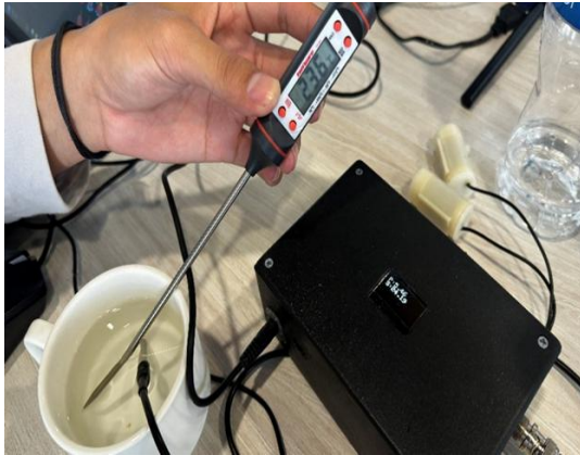
Gambar 10. Tampilan pengujian sensor suhu
