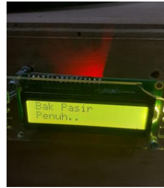
Gambar 17 notifikasi bak pasir sudah terisi penuh
