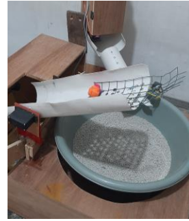
Gambar 11 penyaring membuang kotoran ke penampungan
