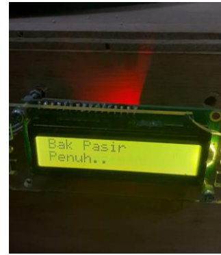
Gambar 17 notifikasi bak pasir sudah terisi penuh
