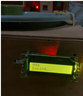
Gambar 9 Tampilan sensor PIR mendeteksi kucing
