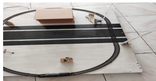
Gambar 13. Sensor Ultrasonik 1 Mendeteksi Kereta Api
