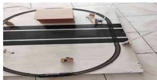
Gambar 13. Sensor Ultrasonik 1 Mendeteksi Kereta Api
