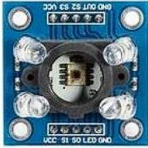
Gambar 3. Sensor warna tcs3200
