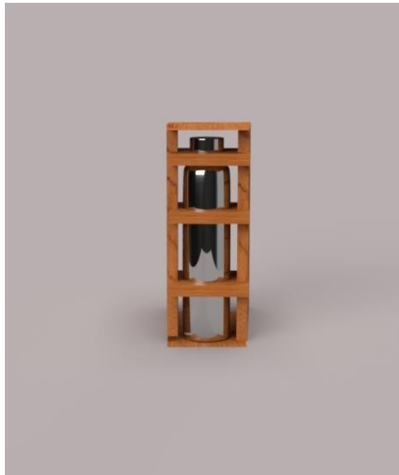
Gambar 6. Ilustrasi Tabung Oksigen 1m 3 Yang Telah Dikemas Dengan Bahan Kemasan Kayu
